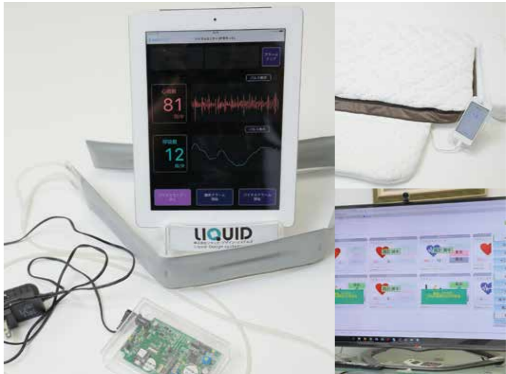
▲試作品「バイタルセンサー」と「表示用アプリケーション」(写真左) / 枕部分のセンサーでバイタル信号をモニタリングしてスマホで表示 (写真右左) / 現在ではクラウドで複数名の情報を集中管理も可能 (写真右下)
